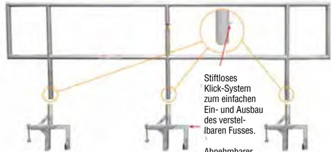
Stiftloses Klick-System zum einfachen Ein- und Ausbau des verstellbaren Fusses.
